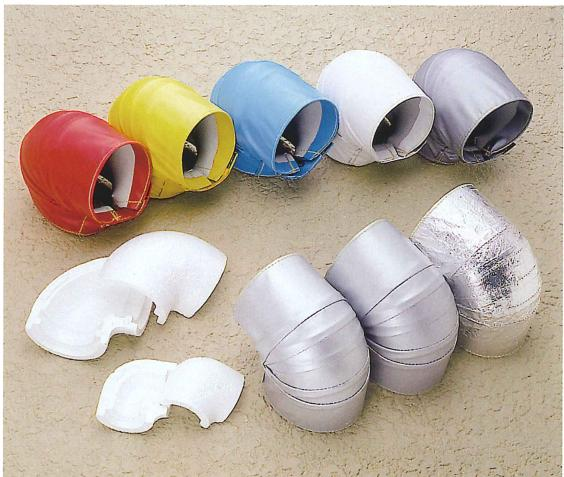
各種コートカバーのエルボ用カバーで、各々の外装材に合わせて加工してあり、取り付けは配管のエルボ部に保温材を取り付け、その上からエルキャップをかぶせマジックテープ部を重ねれば仕上りです。
