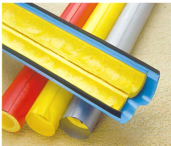
タフコートカバーはグラスコートカバーの外装を強靭な塩ビシートに置き換えた配管用保温材で従来のビニコートカバーをワンランクグレードアップした製品です。外装材は今までのビニールテープ類と異なり伸びて垂れたり・緩んだりする事はありません。この外装シートの安全使用温度は80°Cですが蒸気配管でも表面温度は50°C以下ですので支障はありません。
