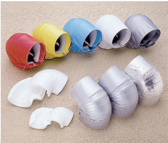
各種コートカバーのエルボ用カバーで、各々の外装材に合わせて加工しており、取り付けは配管のエルボ部に保温材を取り付け、その上からエルキャップをかぶせマジックテープ部を重ねれば仕上りです。
